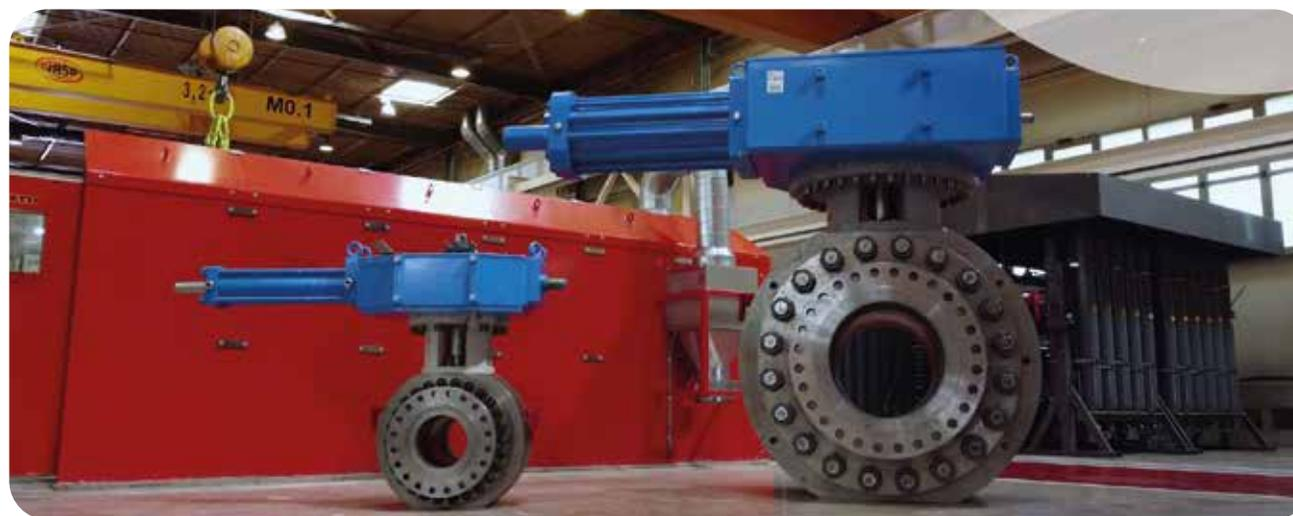
VALVES ha diseñado y fabricado cuidadosamente todas estas válvulas de bola para servicio severo con cierre metálico (slurry pipeline valves), las cuales garantizarán cero fugas en una aplicación realmente severa. Hay que tener en cuenta que los proyectos de mineral de hierro son de los más exigentes en términos de rendimiento. Algunas de las válvulas serán además operadas hidráulicamente.
